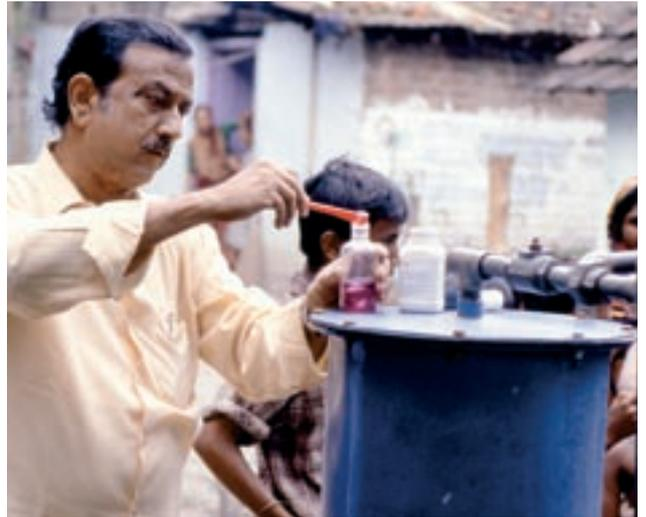
Kalkutta, Indien | Amitava Sengupta vom State Water Investigation Directorate untersucht mit dem Merckoquant® Arsen-Test (hoch sensitiv) eine Wasserprobe.
